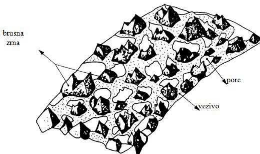
Slika 18. Rezna površina brusne ploče (Izvor: Ciglar, 2018.)
