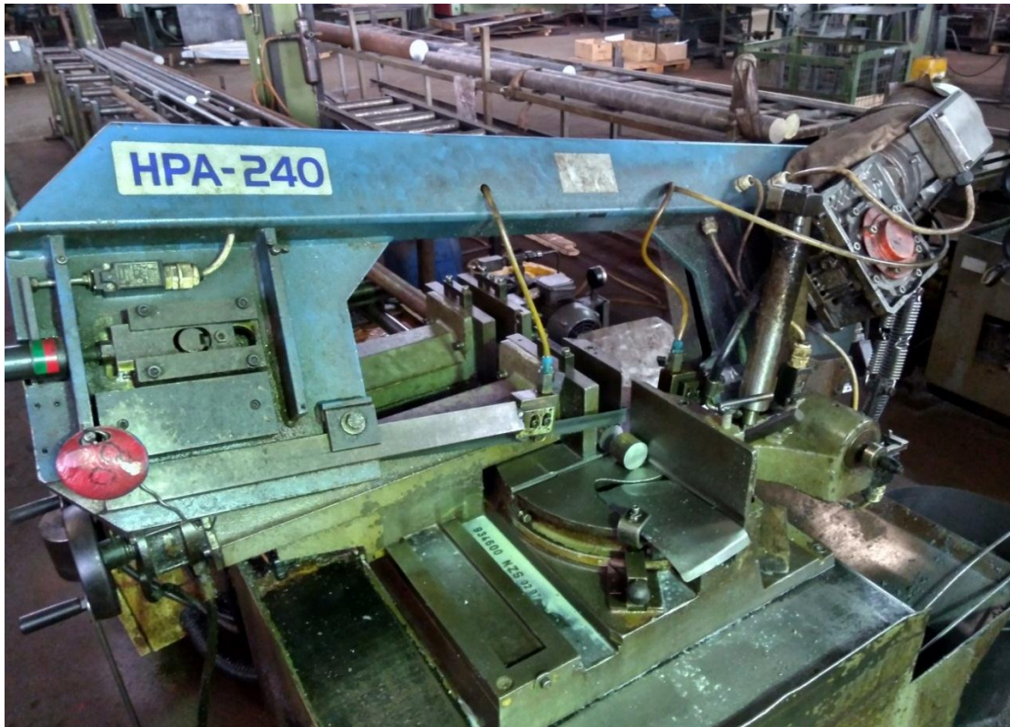
Slika 10. Horizontalna tračna pila (Izvor: autor)
