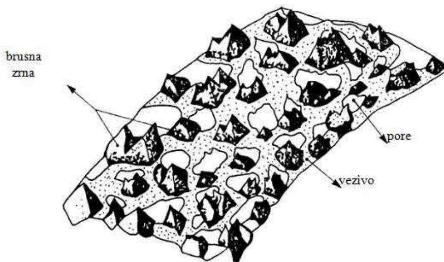
Slika 18. Rezna površina brusne ploče (Izvor: Ciglar, 2018.)
