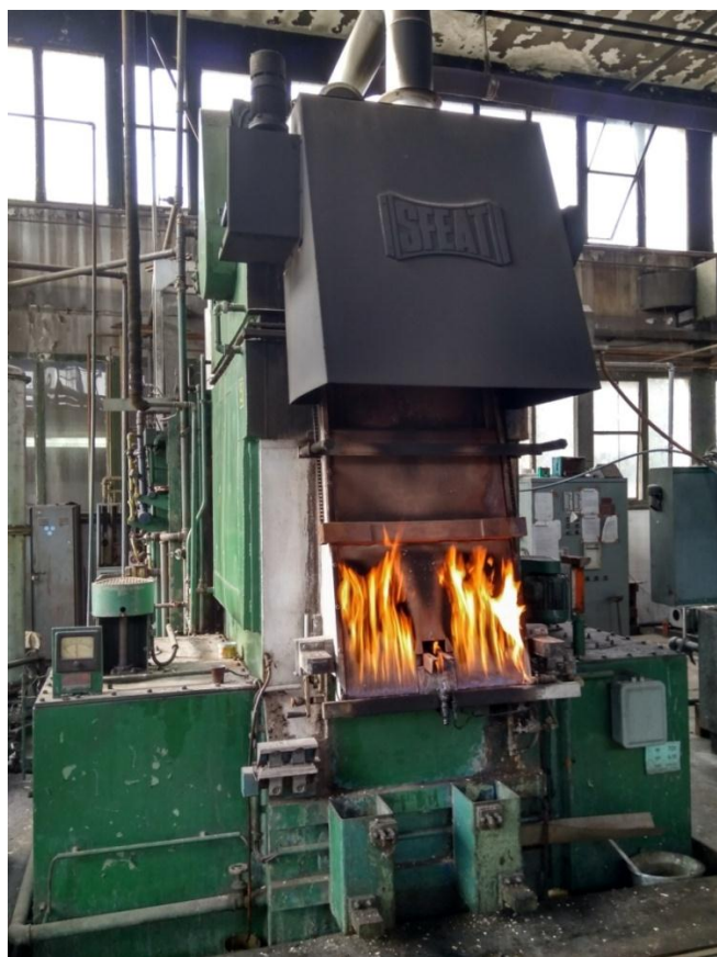
Slika 26. Komorna peć za pougljičavanje sa plinovitim sredstvima (Izvor: autor)
