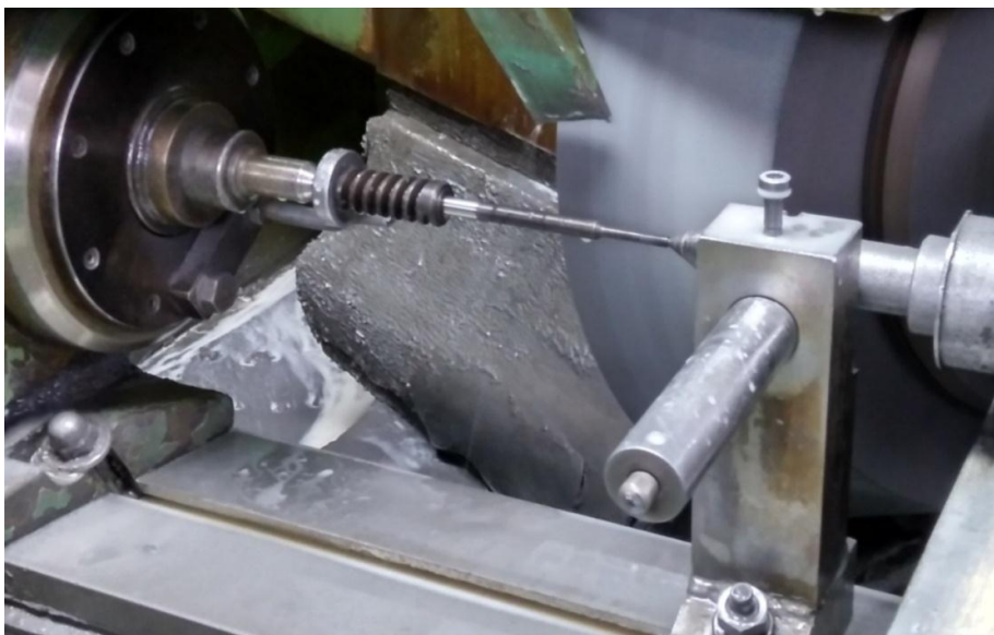
Slika 20. Završno brušenje promjera \text{Ø}10\text{h}7 pužnog vratila (Izvor: autor)
