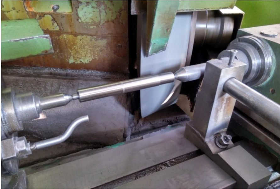
Slika 19. Brušenje tehnološke baze (Izvor: autor)
