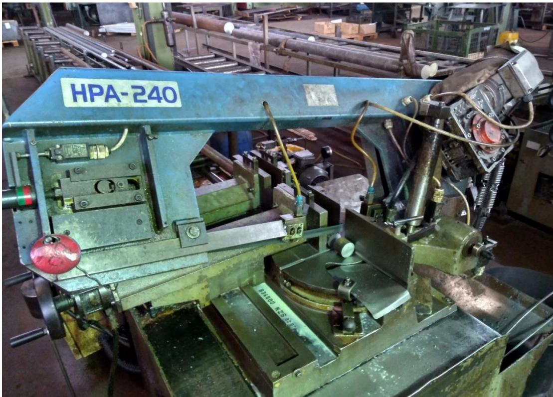
Slika 10. Horizontalna tračna pila (Izvor: autor)
