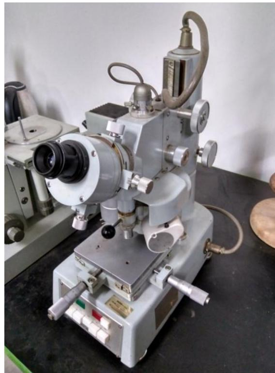
Slika 30. Mjerni mikroskop za mjerjenje tvrdoće prema Vickers metodi (Izvor: autor)
