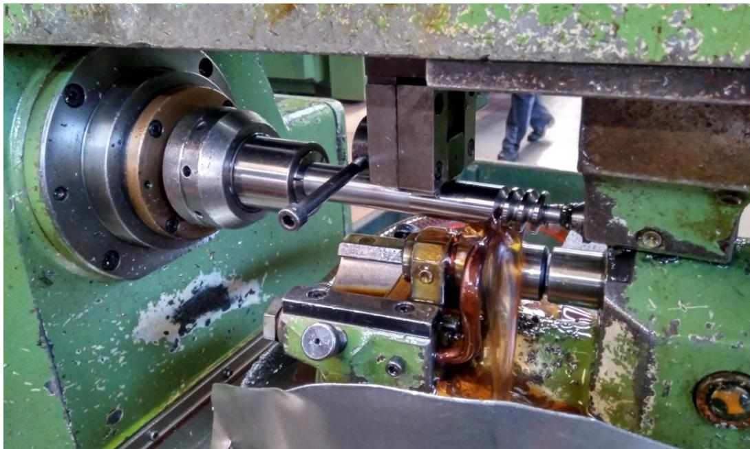
Slika 23. Izrada zavoja pužnog vratila na glodalici "Koepfer 400". (Izvor: autor)
