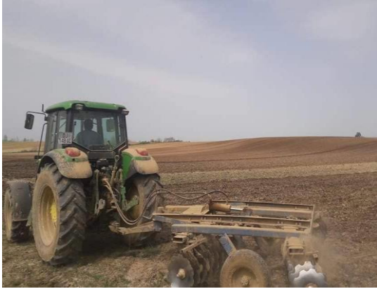
Slika 8. Predsjetvena obrada tla tanjuračom
