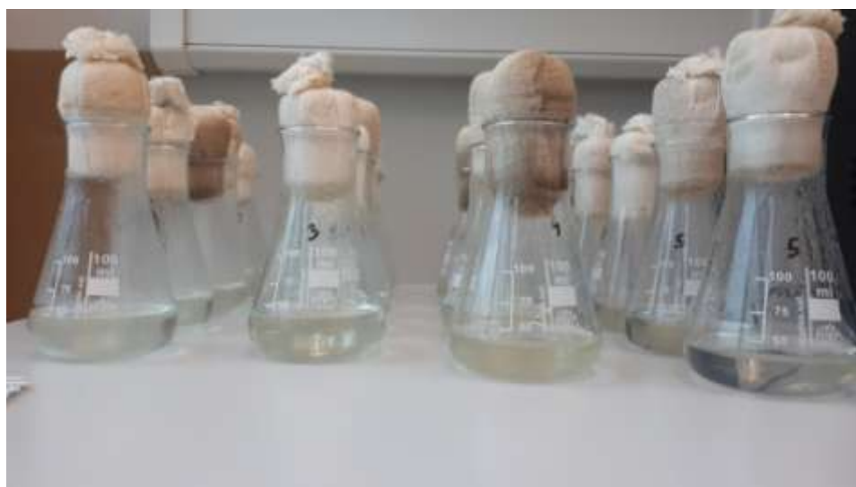
Slika 8. Izgubljena hranjiva podloga isparavanjem bez prisutnosti staklene laboratorijske čaše (izvor: Matić)
