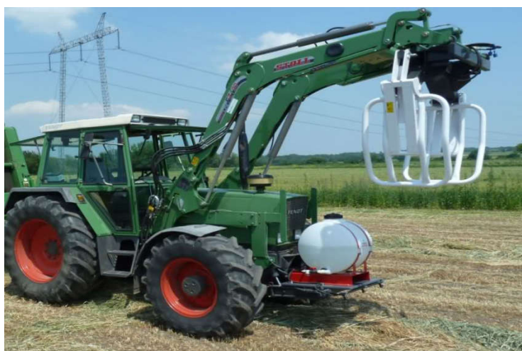
Slika 16 . Traktor FENDT s prednjim utovarivačem (link 8.)
