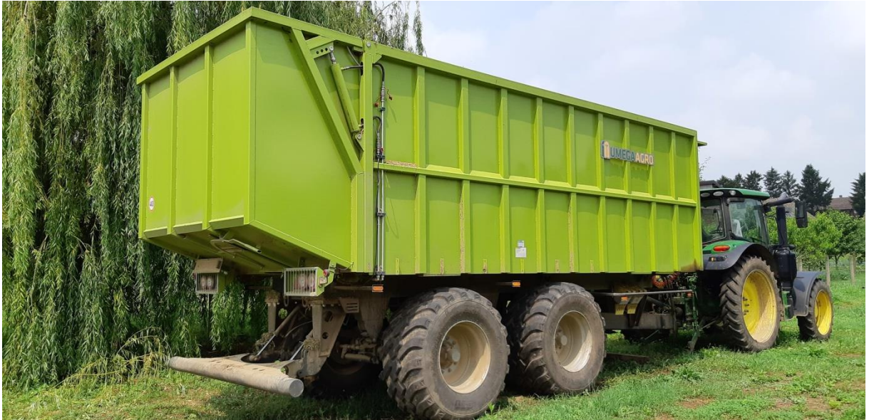
Slika 22. Potisna prikolica Umega PI20 (Izvor: vlastita fotografija)
