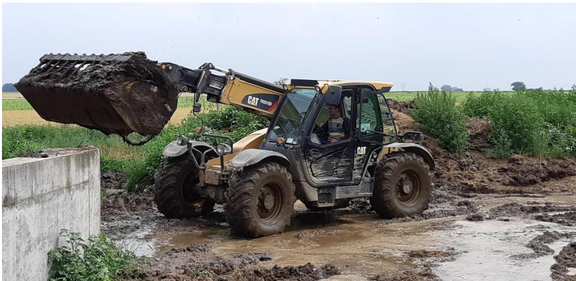
Slika 6. Teleskopski utovarivač Caterpillar 3510D (Izvor: vlastita fotografija)
