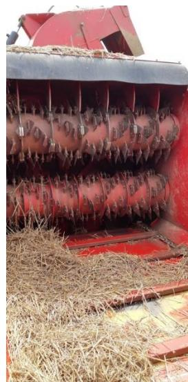
Slika 18. Noževi za sjeckanje slame (Izvor: vlastita fotografija)
