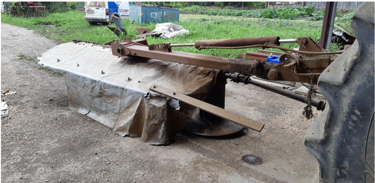
Slika 16. Traktorska kosilica SIP Roto 311 (Izvor: vlastita fotografija)
