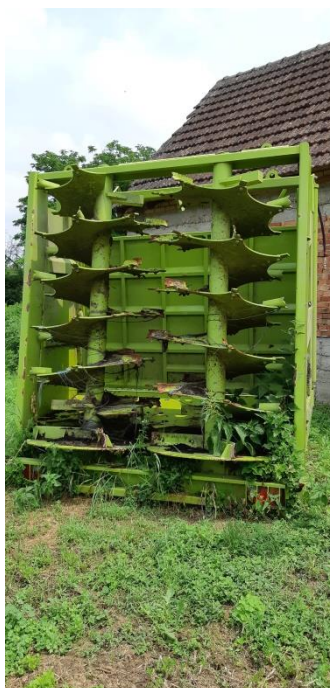
Slika 23. Zamjenska stranica s razbacivačima stajnjaka za prikolicu Umega PI20 (Izvor: vlastita fotografija)
