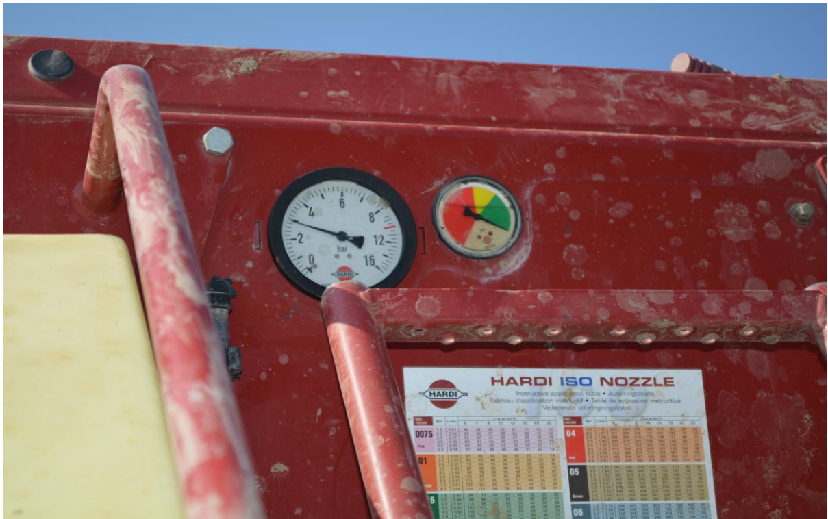
Slika 9. Ispitivani manometar tvrtke Hardi (privatna fotografija)
