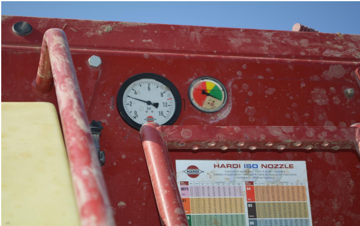
Slika 9. Ispitivani manometar tvrtke Hardi (privatna fotografija)
