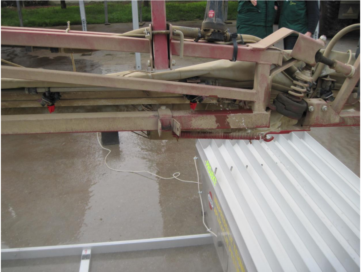
Slika 6. Mjerenje raspodjele tekućine pomoću uređaja Hardi Spray Scanner (Izvor: foto original M.Glavaš)
