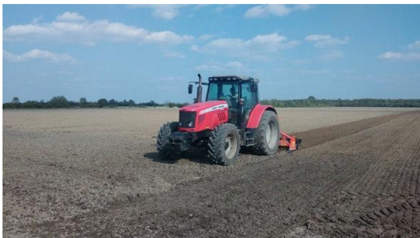
Slika 11. Predsjetvena priprema tla rotacijskom drljačom s packer valjkom u kasno ljetnom roku sjetve lucerne (Foto: M. Brlić)
