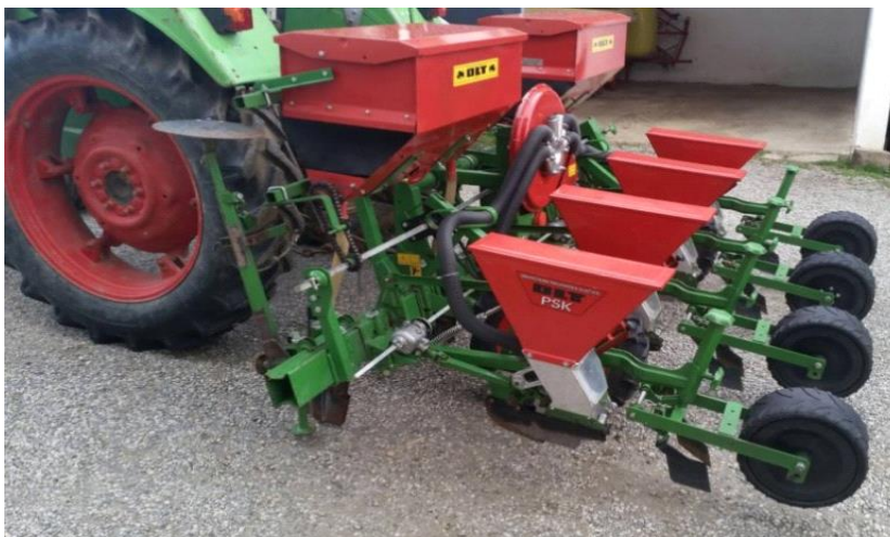
Slika 4. Pneumatska sijačica (Izvor: Banaj, 2016.)
