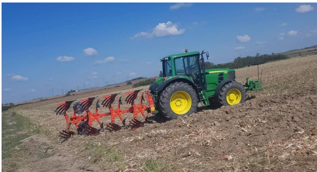
Slika 6. Plug „Kuhn Multi Master 122“ i traktor „John Deere 6930 Premium“ u osnovnoj obradi (Izvor: Marin Kolić)
