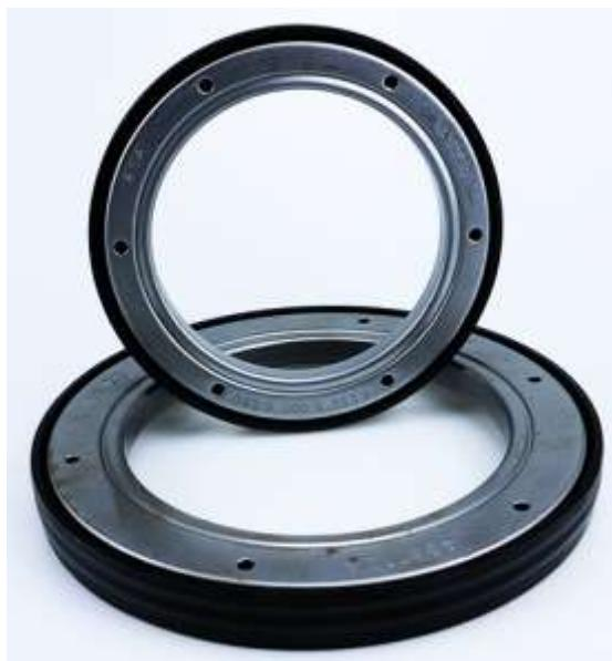
Slika 24. Metalne uljne brtve za traktor
