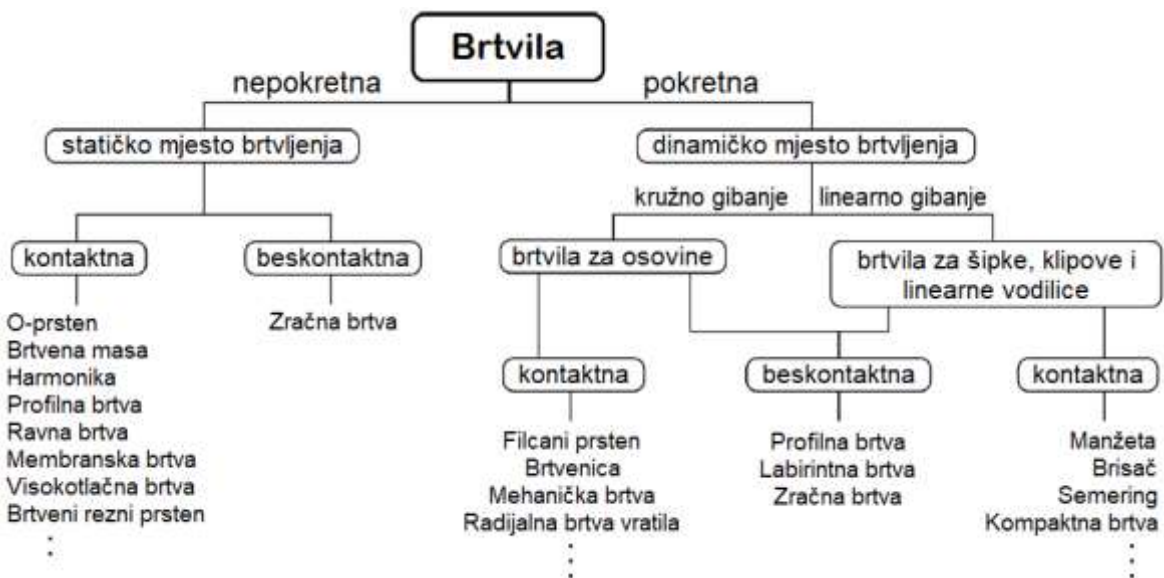
Slika 2. Podjela brtvljenih spojeva (Izvor: Haas, 2014.)
