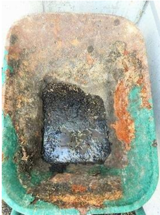
Slika 24. Agresivno djelovanje digestata na kolica za čišćenje postrojenja
