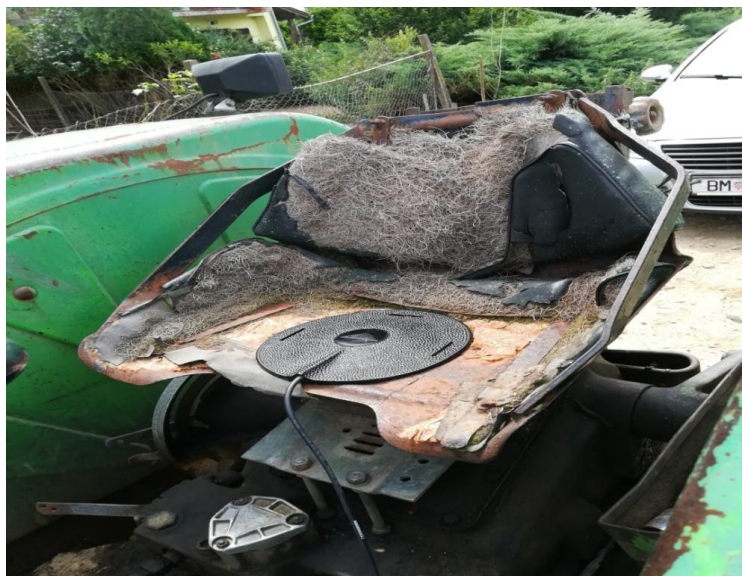
Slika 8. Prikaz postavljanja mjernog uređaja na sjedalicu (izvor: Ivan Kamenčak, 2019.)
