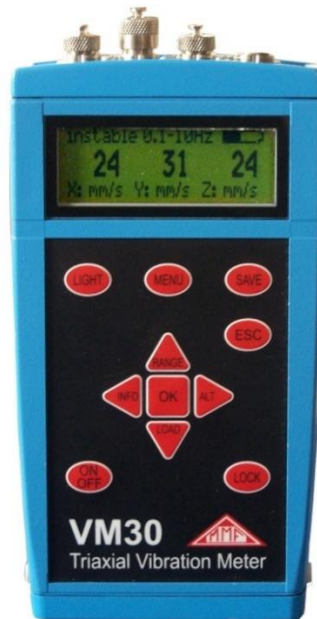
Slika 15. Uređaj za mjerenje vibracija MMF VM30
