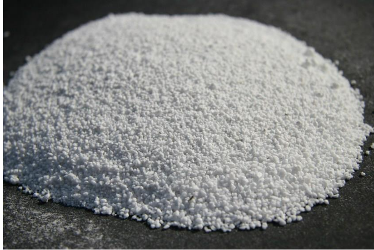
Slika 4. Vulkanski pijesak (perlit) ( www.archiproducts.com/es/productos/ )
