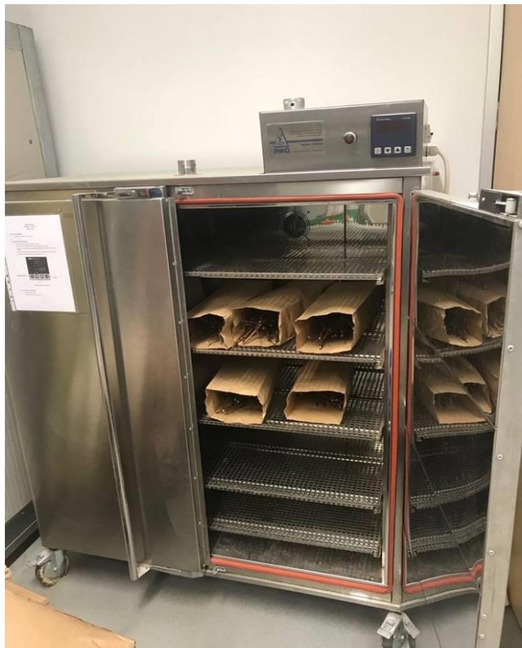
Slika 10. Priprema uzoraka za sušenje u sušioniku
