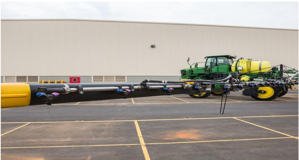
Slika 25. Grana traktorske prskalice – karbonska vlakna i epoxy
