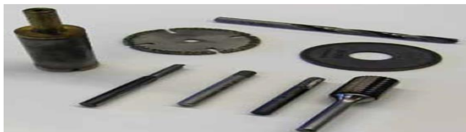
Slika 32. Alati za bušenje i rezanje kompozita
