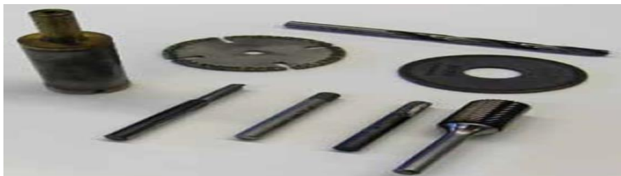
Slika 32. Alati za bušenje i rezanje kompozita
