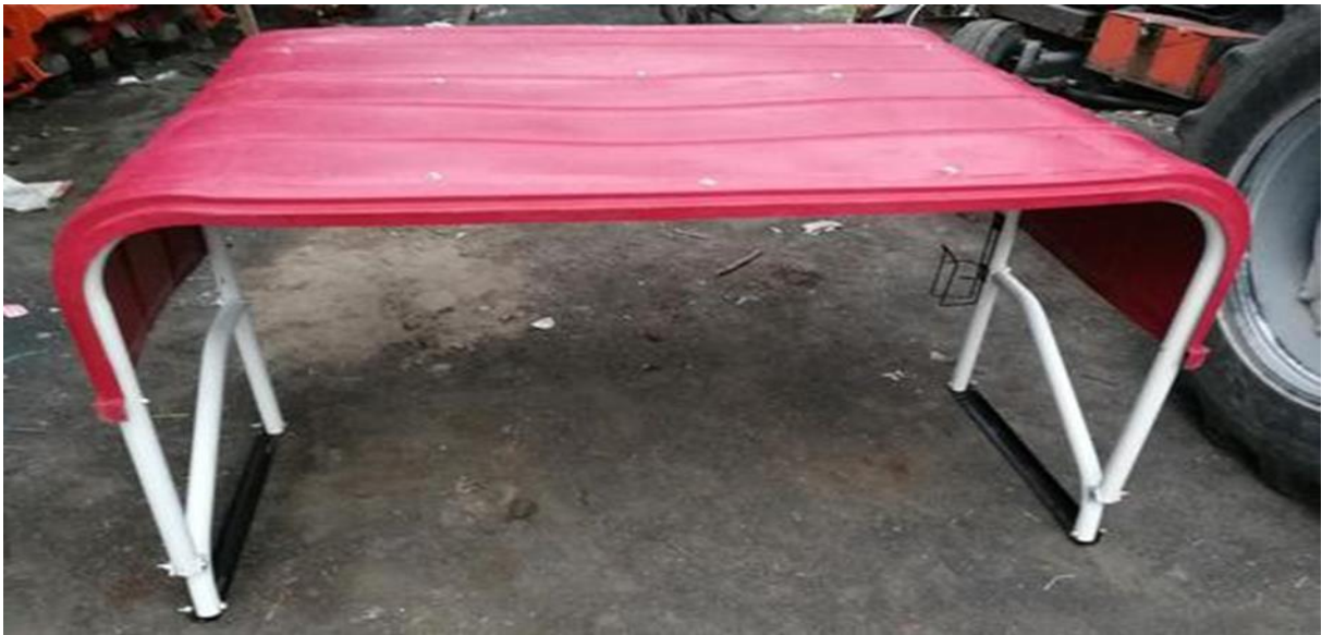
Slika 27. Traktorski krov (PVC)
