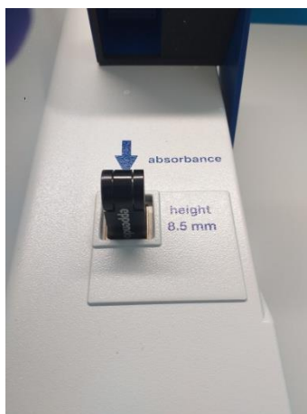
Slika 20. Postavljanje UV kivete u spektrofotometar (foto original: A. Stilin)
