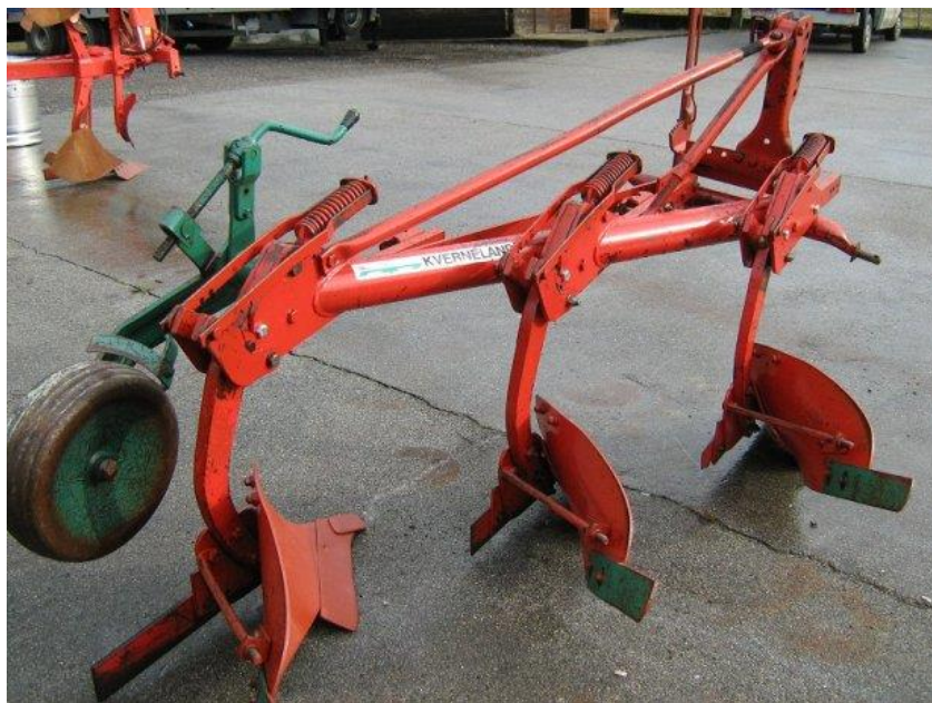
Slika 3. Trobrazdni plug Kvernerland
