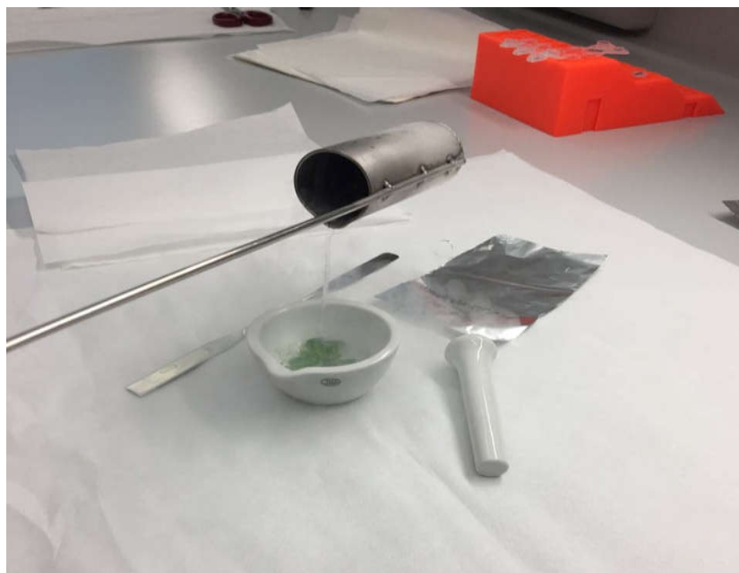
Slika 6. Dodavanje tekućeg dušika (foto original: M. Lovrić)
