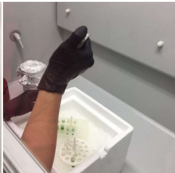
Slika 12. Dodavanje kloroform-izoamil alkohola (foto original: M. Lovrić)
