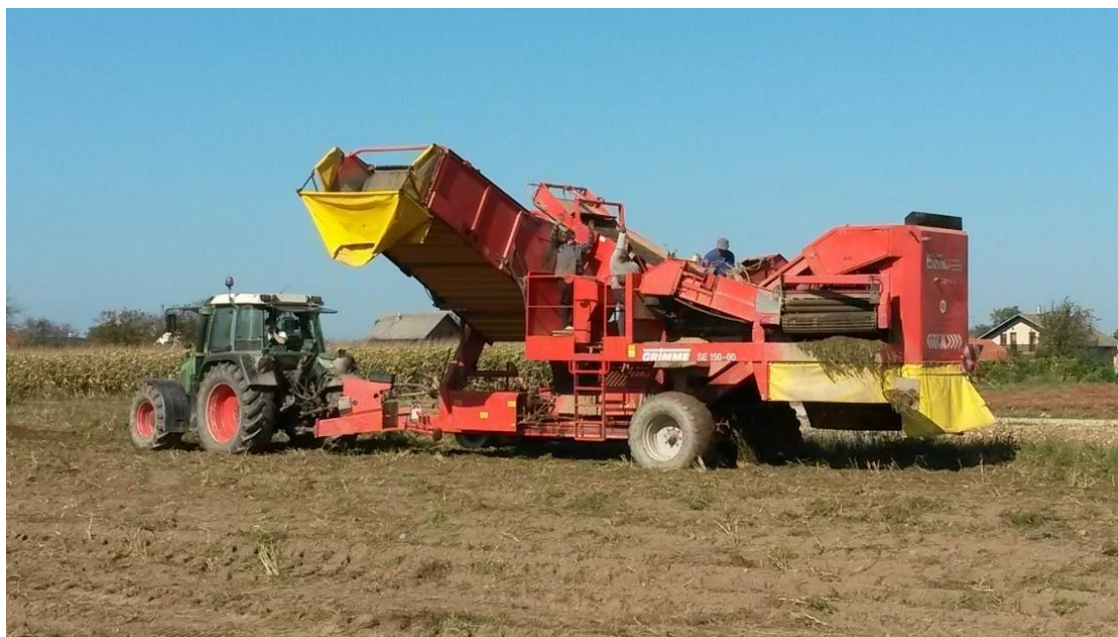
Slika 19. Dvoredni kombajn za vađenje krumpira vučen traktorom ( Foto: Anja Kolarić )
