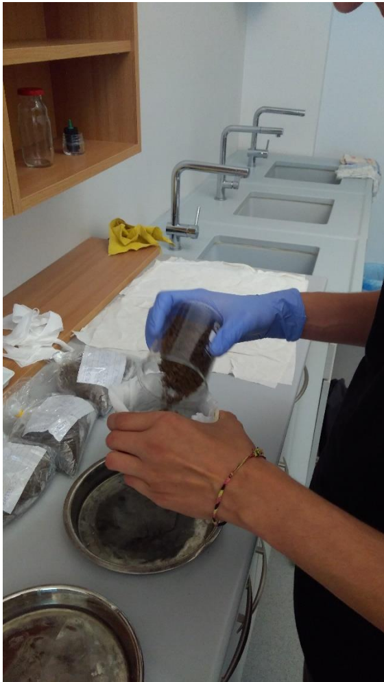
Slika 22. Punjenje sita Foto: Poturiček L.
