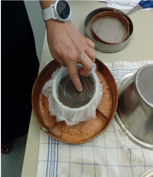
Slika 26. Ekstrakcijsko sito sa satnim stalom
