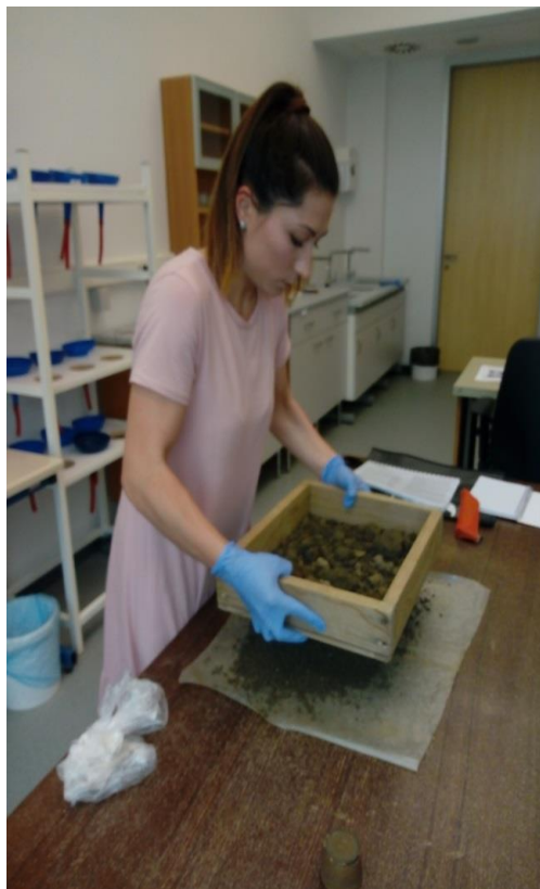
Slika 31. Prosijavanje tla (Foto: L. Pavlic)
