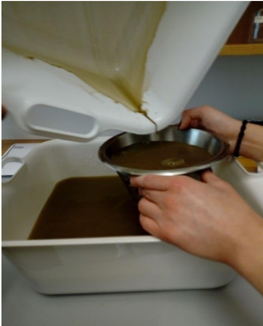
Slika 23. Pretakanje kroz sito od 45 \mu\text{m}
