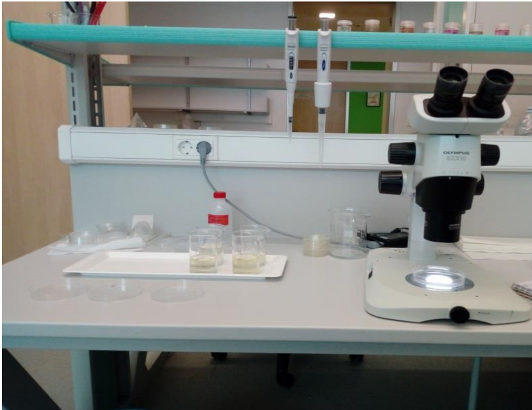
Slika 34. Mikroskop za prebrojavanje nematoda (Foto: L. Pavlic)
