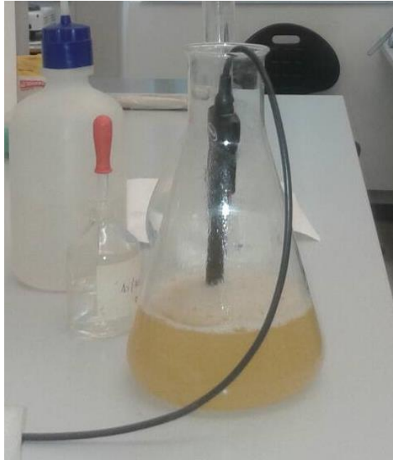
Slika 10. Očitavanje pH vrijednosti podloge (Izvor: Autor)
