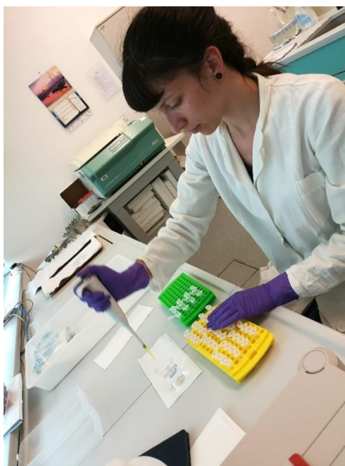
Slika 14. Pipetiranje uzoraka za spektrofotometrijsko mjerenje antioksidativnih aktivnosti (Josipa Rupčić)
