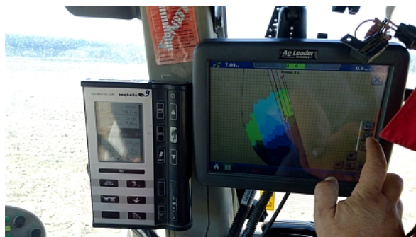
Slika 11. Kalibrator Bogballe ZURF i prikaz preporuke gnojidbe na monitoru Integra (Izvor: Stracenski, 2015.)
