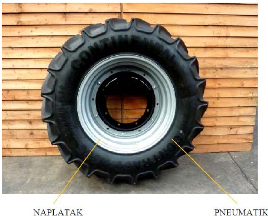
Slika 1. Glavni dijelovi kotača (autor)
