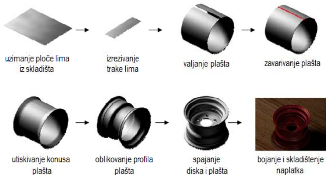
Slika 6. Shema pojednostavljenog tehnološkog procesa izrade čeličnog naplatka ( http://www.sfsb.unios.hr/kth/zavar1/files/IP%202005%20-%20PDF/6-5.pdf )
