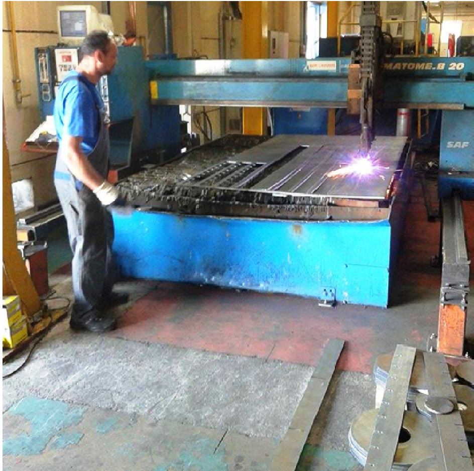
Slika 8. Rezanje traka lima na uređaju za rezanje limova plazmom (autor)
