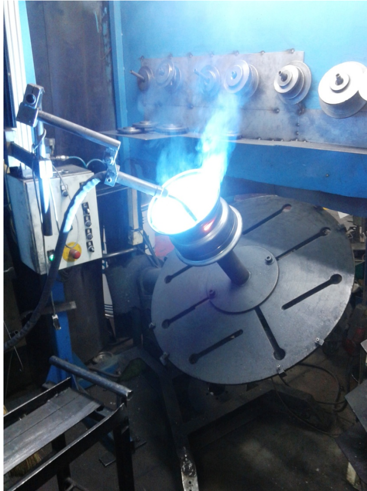
Slika 25. Zavarivanje plašta i diska (autor)
