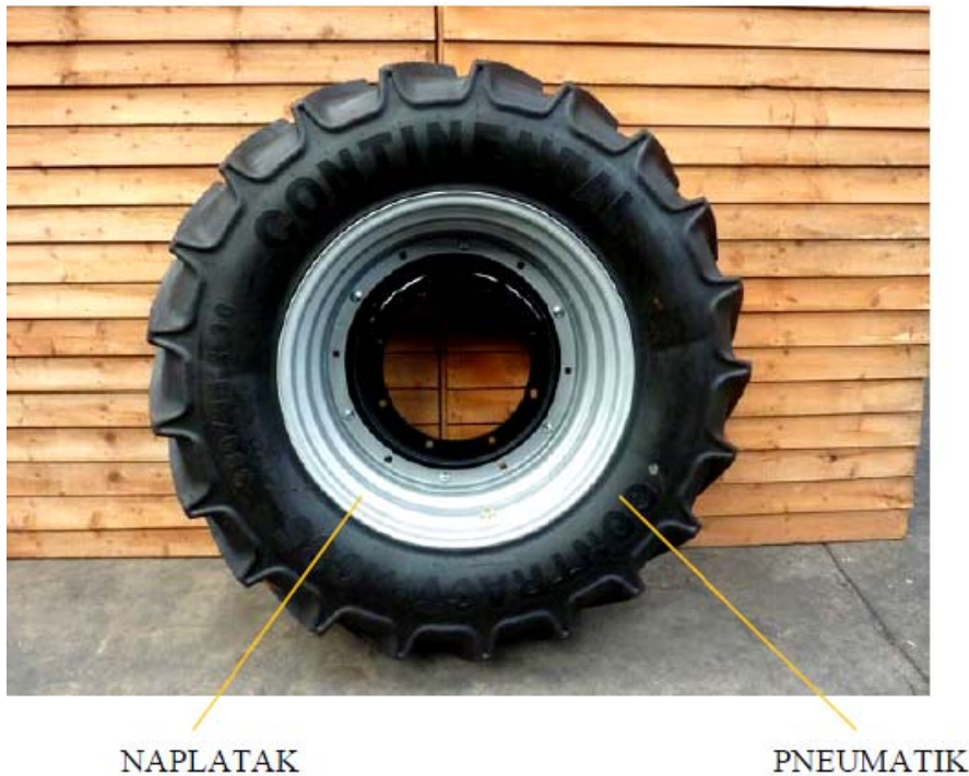
Slika 1. Glavni dijelovi kotača (autor)
