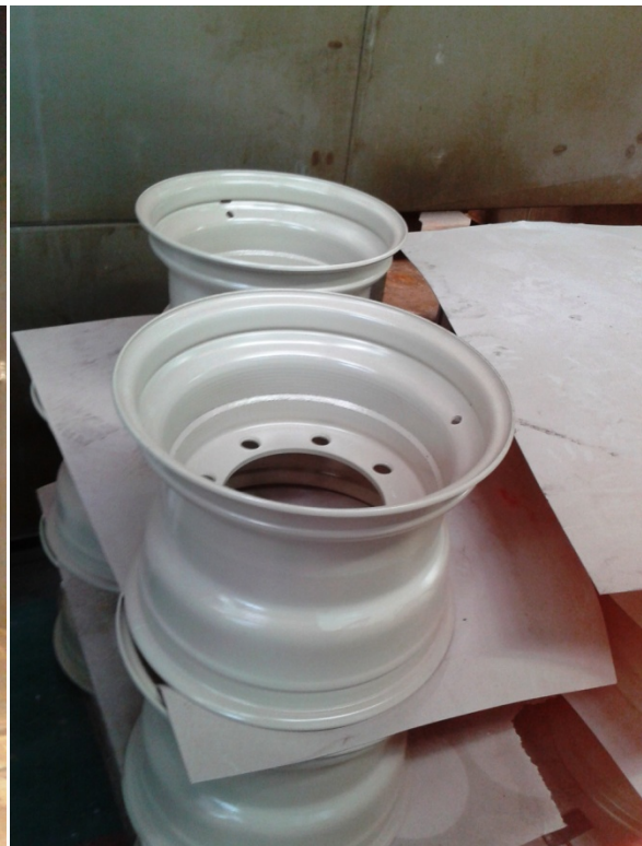
Slika 27. Komora za bojanje (autor) Slika 28. Naplatak obojan temeljnom bojom (autor)
