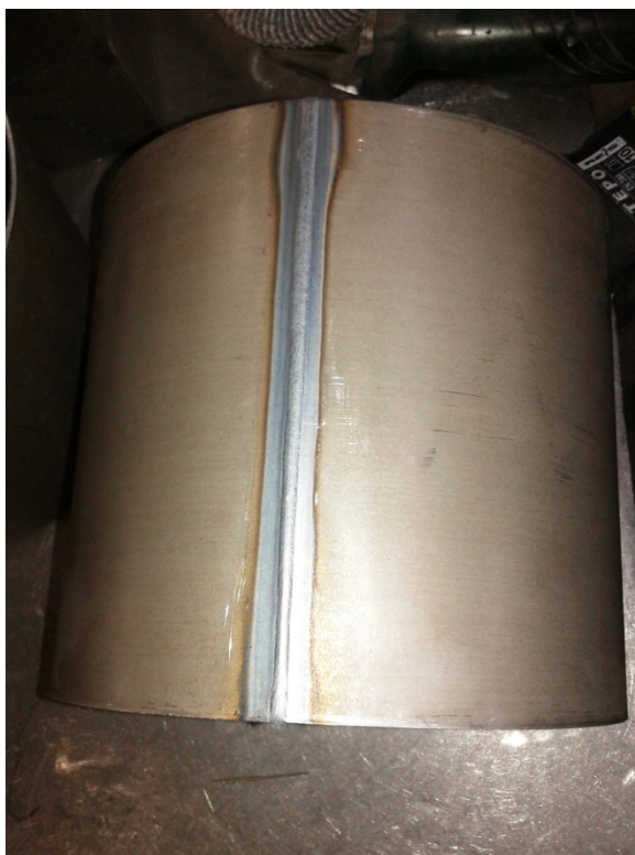
Slika 19. Zavareni plašt naplatka (autor)
