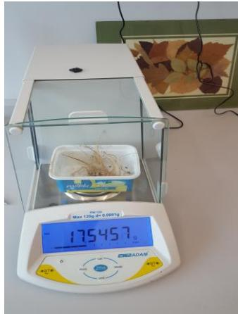
Slika 24. Vaganje uzorka na preciznoj digitalnoj vagi (fotografija: Avreljo, A., 2019.)
