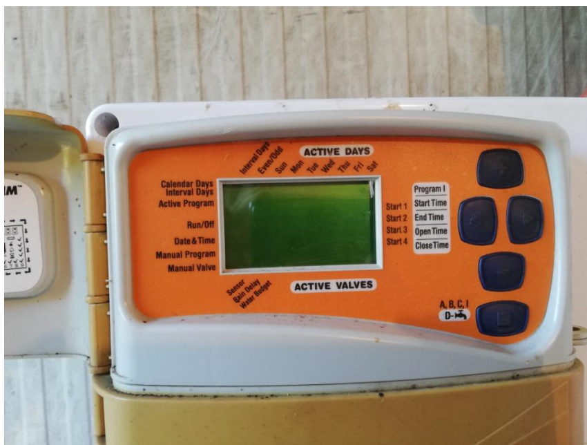
Slika 12: Računalo pomoću kojega se određuju dani i sati paljenja i gašenja navodnjavanja izvor: Mirna Škoro (2019.)
