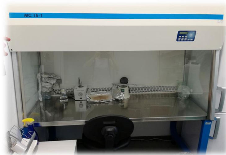
Slika 14. Laminarni kabinet FAZOS (Foto: Milaković, 2019.)
