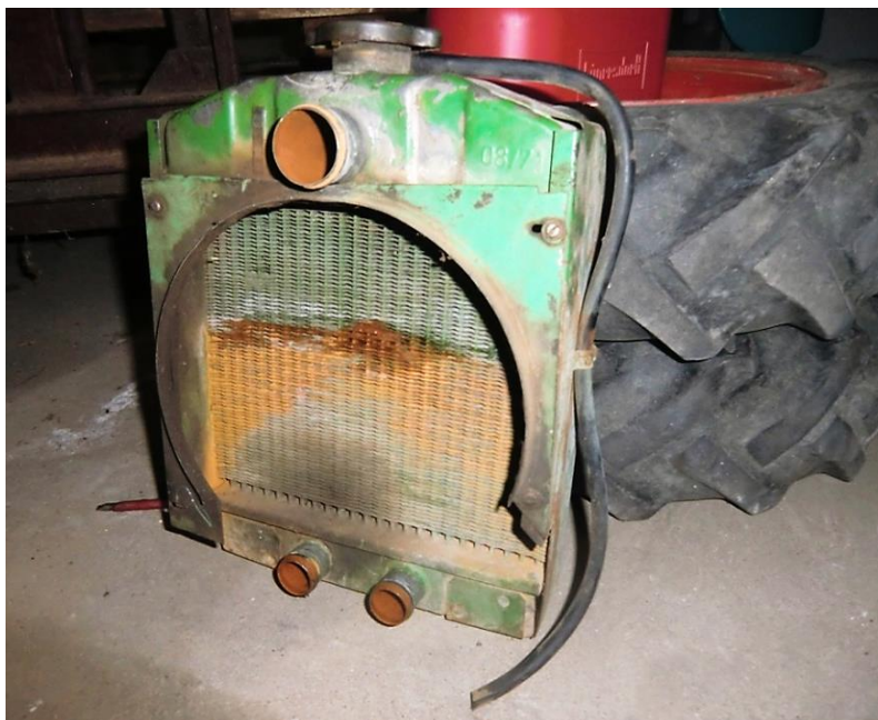
Slika 24. Primjer oštećenog hladnjaka traktora
