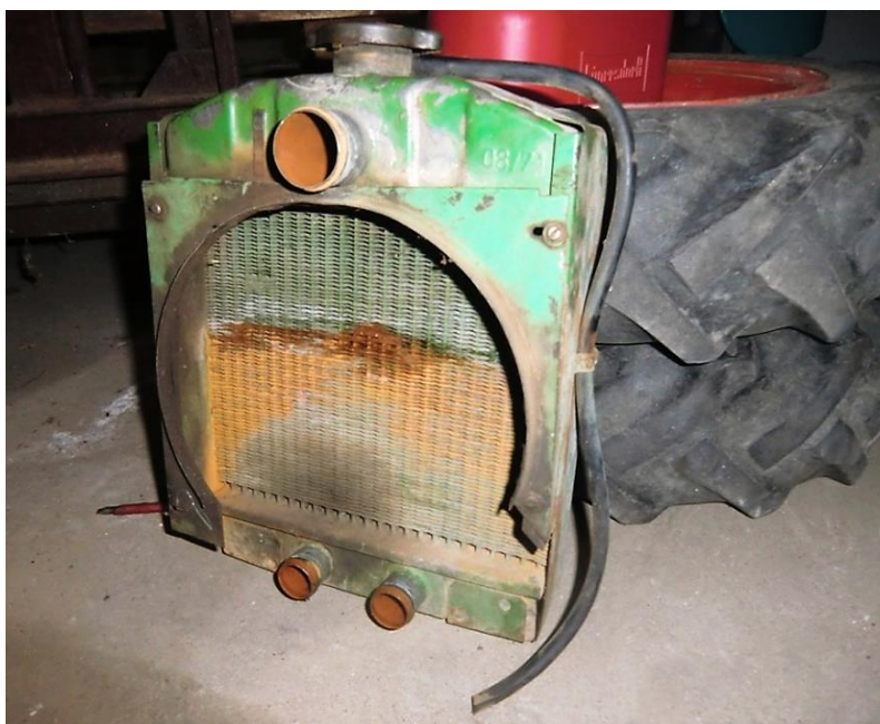
Slika 24. Primjer oštećenog hladnjaka traktora
