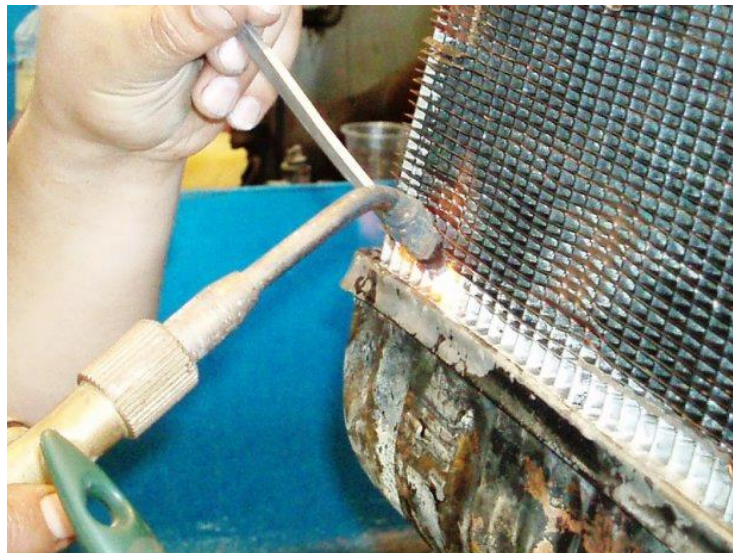
Slika 26. Popravak rashladnog bloka hladnjaka plinskim lemljenjem (Izvor: https://karosserie-birgmann.de/kuehlerinstandsetzung/ )
