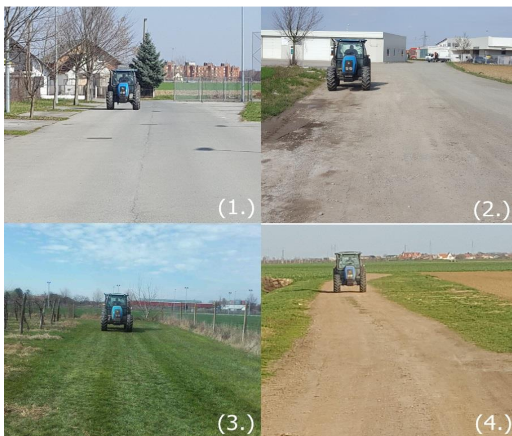
Slika 3. Različite agrotehničke podloge po kojima je obavljeno istraživanje (asfalt (1.), makadam (2.), trava (3.) i poljski put (4.))
