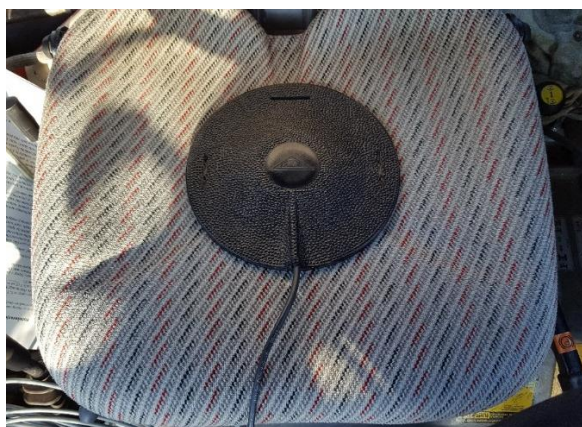
Slika 12. Postavljeni senzor za mjerenje vibracija koje utječu na trup rukovatelja
