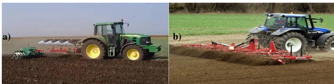
Slika 2. a) Agregat sa plugom i drobilicom i b) Agregat sa sjetvospremačem
