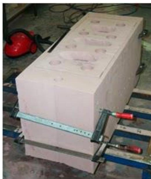
Slika 18. Cjelokupni kalup kućišta motora pripremljen za postupak lijevanja
