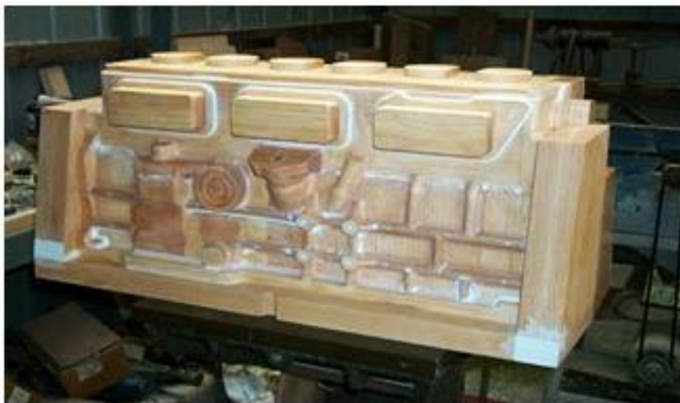
Slika 12. Drveni model vanjskih ploha motora
