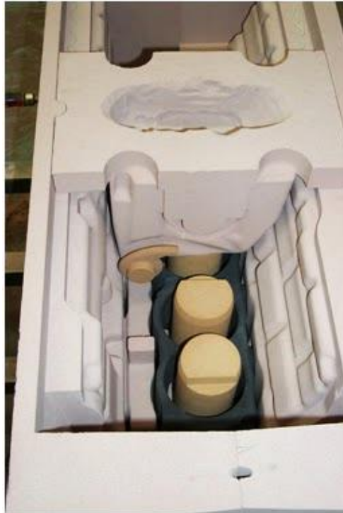
Slika 17. Sastavljanje cjelokupnog kalupa kućišta motora
