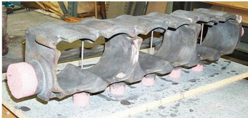
Slika 16. Model cilindarskog prostora motora (sivo) i jezgre za otvore (ružičasto)
