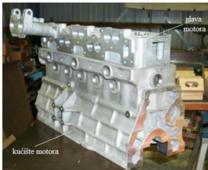
Slika 1. Lijevani dijelovi motora s unutarnjim izgaranjem
