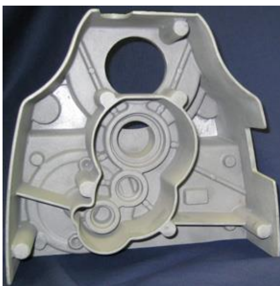
Slika 9. Al-odljevak iz gipsanog kalupa
