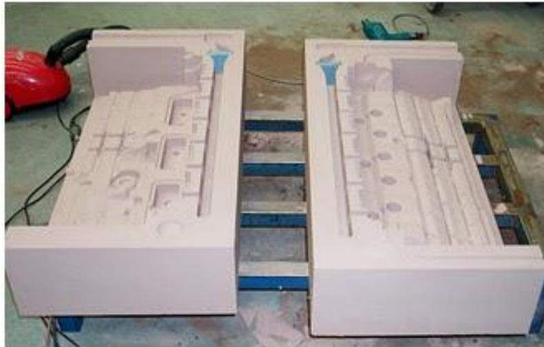
Slika 13. Stranice pješčanog kalupa vanjskih ploha kućišta motora
