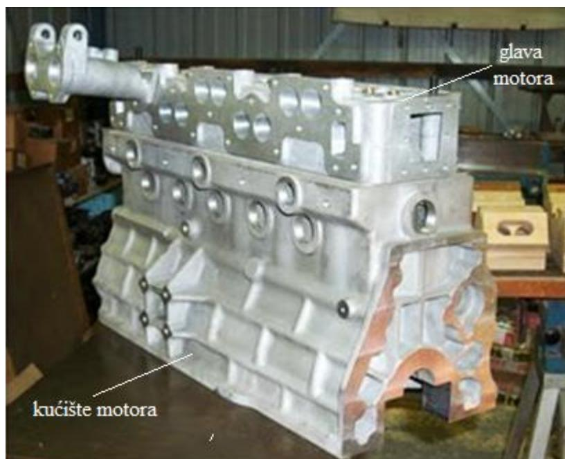
Slika 1. Lijevani dijelovi motora s unutarnjim izgaranjem
