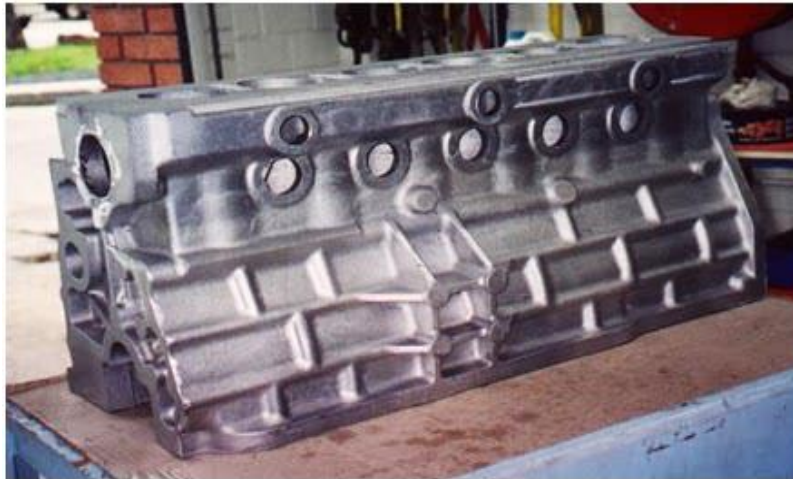
Slika 19. Odljevak kućišta motora nakon čišćenja od kalupnog pijeska
