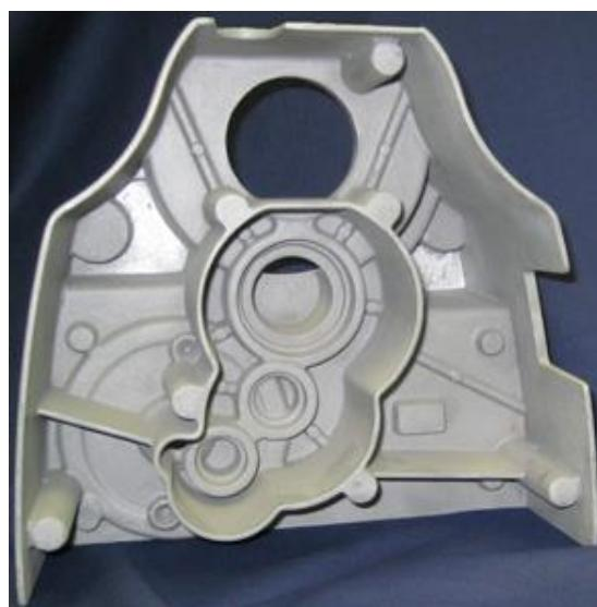
Slika 9. Al-odljevak iz gipsanog kalupa
