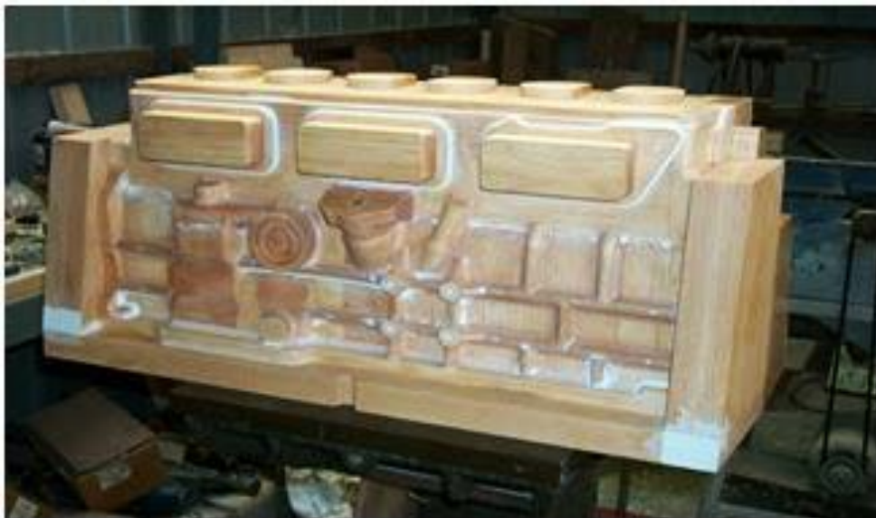
Slika 12. Drveni model vanjskih ploha motora
