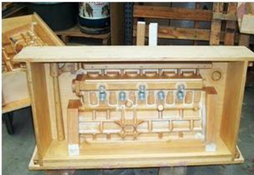
Slika 14. Model unutrašnjeg oblika kućišta motora
