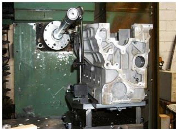
Slika 20. Obrada odlivenog kućišta motora na alatnom stroju
