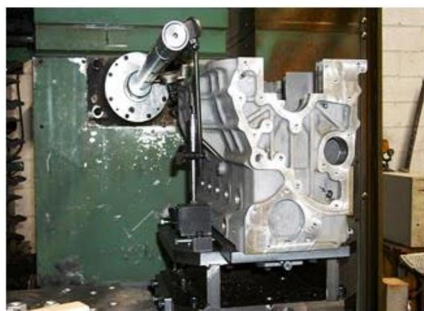
Slika 20. Obrada odlivenog kućišta motora na alatnom stroju
