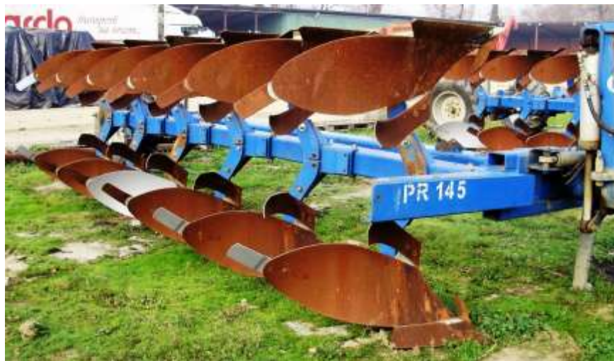
Slika 11. Korozija pluga (Izvor: Andrić, 2017.)
