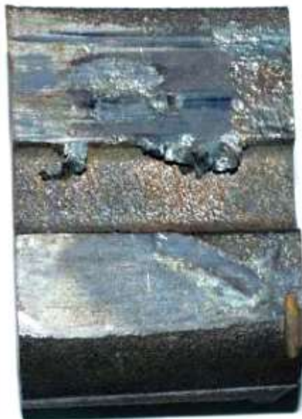
Slika 3. Klizno trošenje kočione obloge od sivog lijeva (Izvor: Rede, 2017.)
