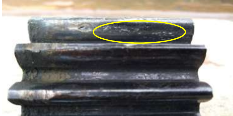
Slika 26. Jamičenje bokova planetarnog zupčanika (Izvor: Dario Raić, 2019.)
