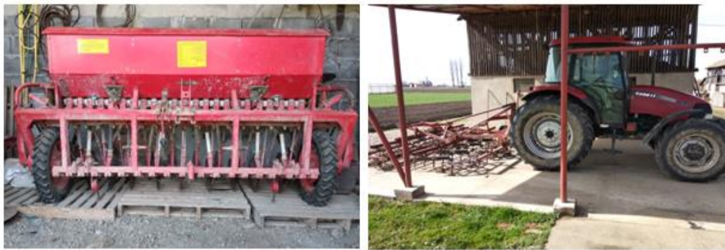
Slika 7. Mehanizacija za sjetvu – žitna sijačica i drljača (izvor: Jurić)
