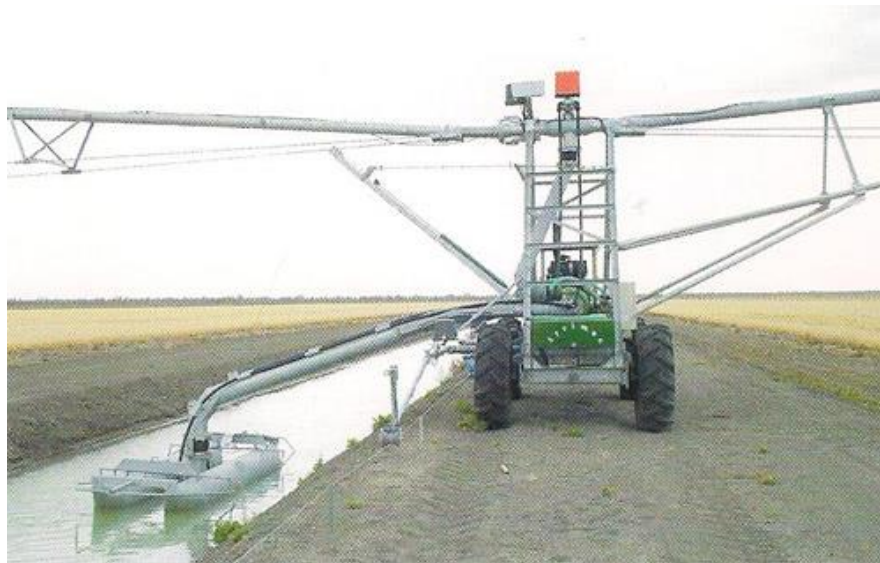
Slika 11. Prenosivi sustav navodnjavanja
