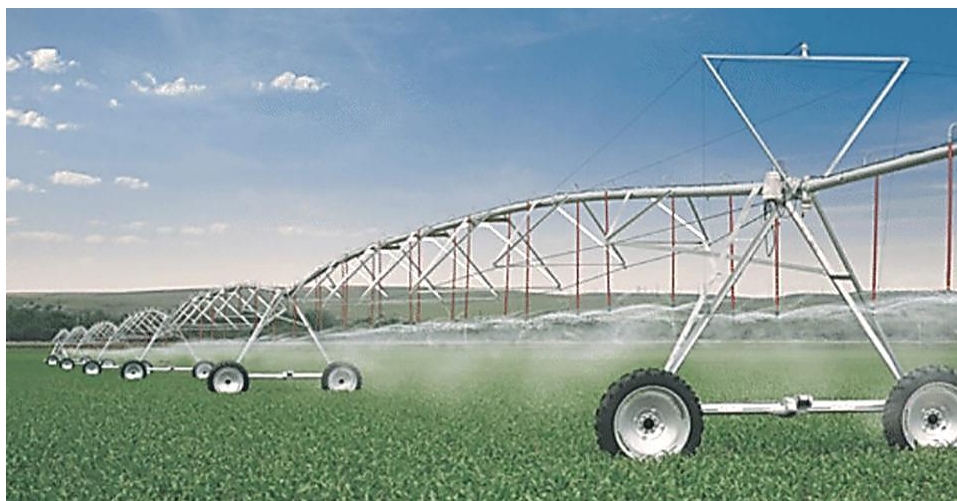
Slika 16. Samohodni automatizirani uređaj za linijsko ili kružno navodnjavanje (Izvor: https://totaleden.com.au/centre-pivots-linear-irrigation/ )
