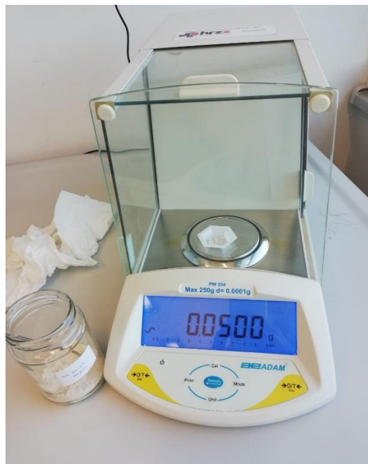
Slika 13. Vaga za odvagu inertnih prašiva (izvor: D. Lončar)
