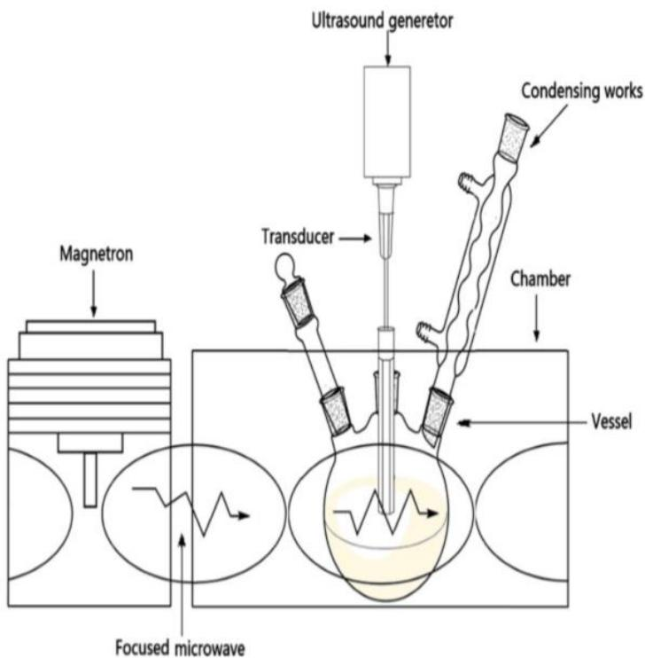
**Slika 19:** Shematski prikaz uređaja za ultrazvučno-mikrovalnom ekstrakciju (UMAE)
