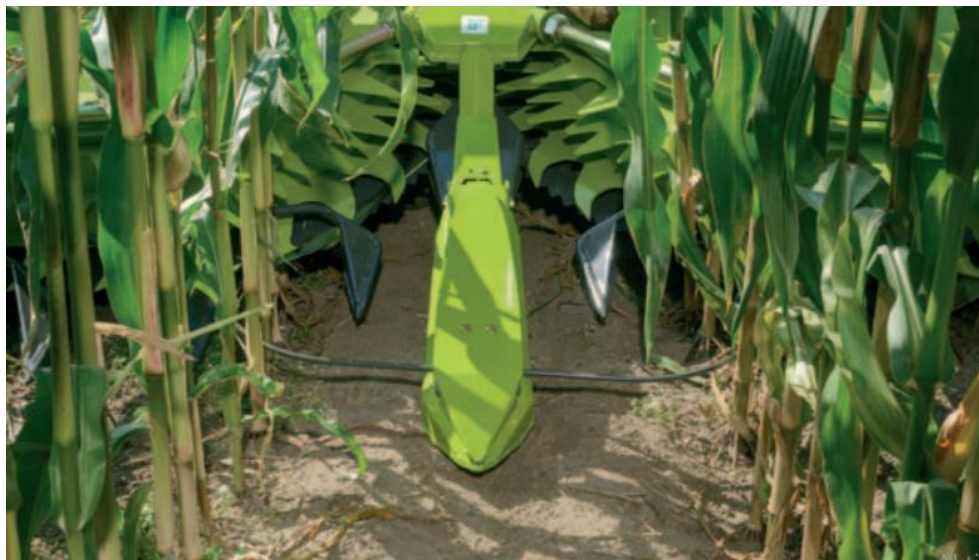
Slika 11. Razdjeljivači s dodirnim tipkalima (Izvor: https://www.claas.co.uk )
