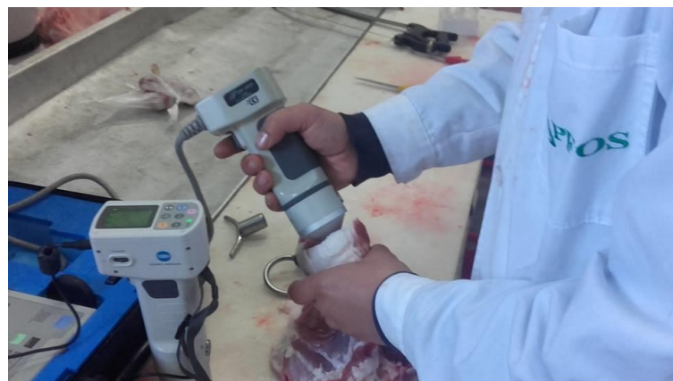
Slika 113. Određivanje boje mesa pomoću Minolta kolorimetra
