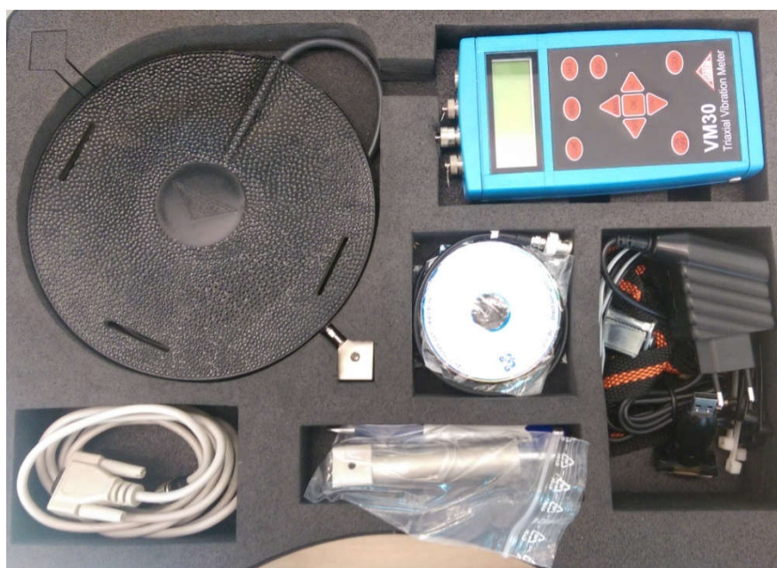
Slika 5. Uređaj za mjerenje traktorskih vibracija MMF VM 30 (izvor: vlastita fotografija)
