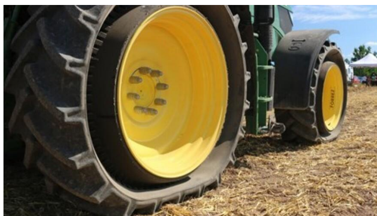
Slika 34. Gume gusjenice (Izvor: https://www.agroklub.com/ratarstvo/novim-dizajnom-guma-protiv-zbijanja-tla/21426/ )
