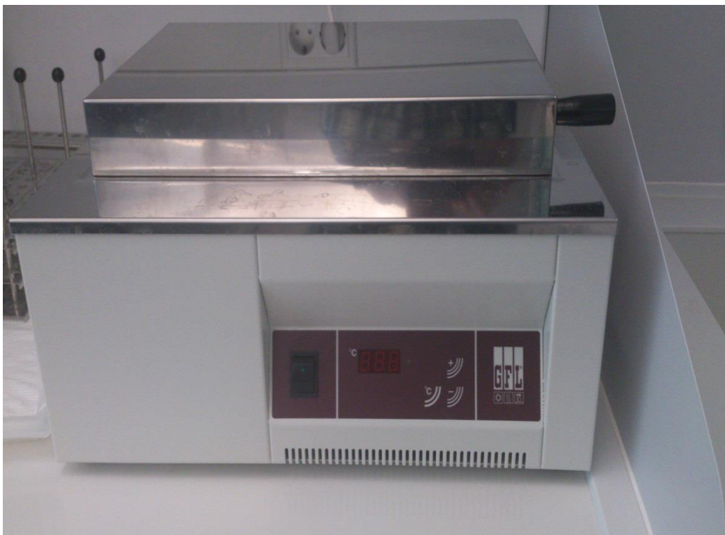
Slika 4. Vodena kupelj (foto original; Z. Martinov)
