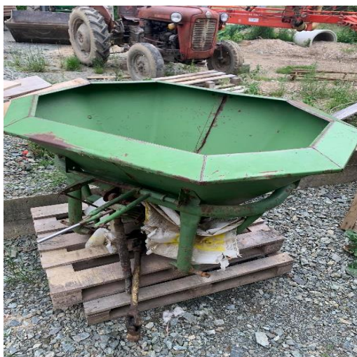
Slika 13. Rasipač Amazone A-E 402 (Izvor: Lea Zdunić)
