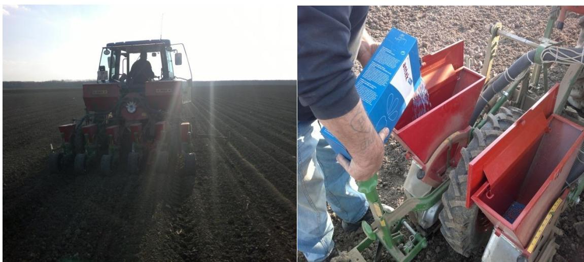
Slika 6. Sjetva šesterorednom sijačicom (lijevo) i sjetva sjemena Antek (desno), Strube
