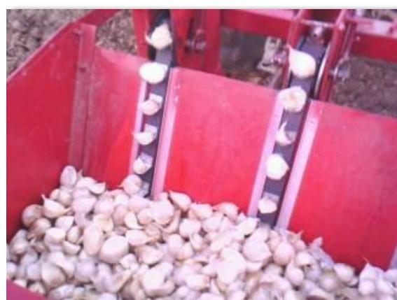
**Slika 3.** Princip rada sadilice
