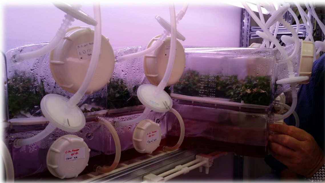
Slika 4. TIB sustav bioreaktora – Katedra za voćarstvo, vinogradarstvo i vinarstvo, FAZOS (Izvor: Bošnjak, 2020.)
