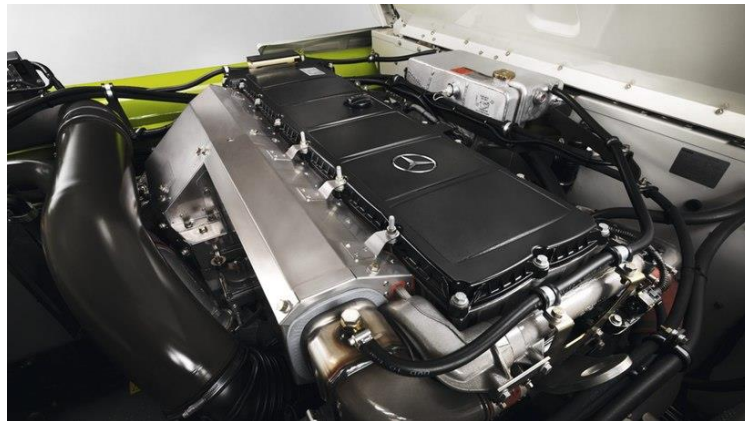
Slika 6. Motor sa unutrašnjim izgaranjem na kombajnu tvrtke Claas
