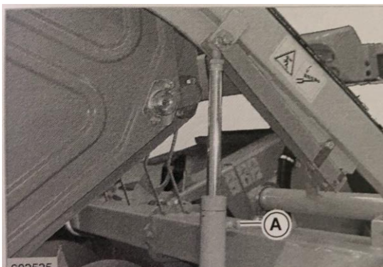
Slika 20. Prikaz kako odzračiti cilindar vitla
