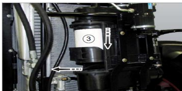
Slika 36. Prikazuje zamjenu filtera zraka motora (Izvor: Radionički priručnik ARION 960 CLAAS , 2019.).
