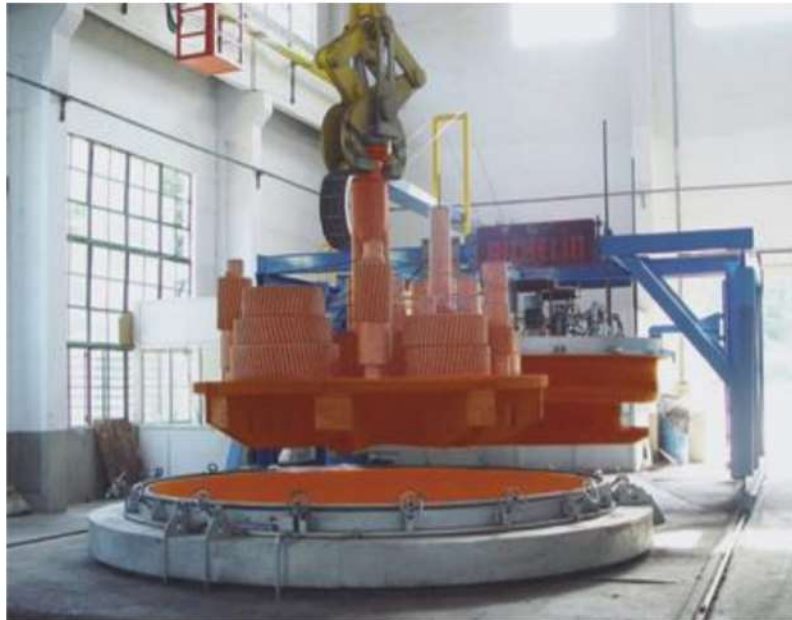
Slika 25. Vertikalna jamska vakuumska peć
