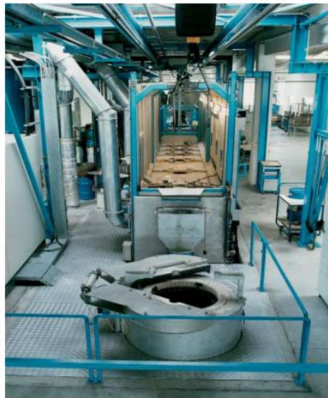
Slika 19. Automatizirana linija za nitrokarburiranje Tenifer QPQ postupkom
