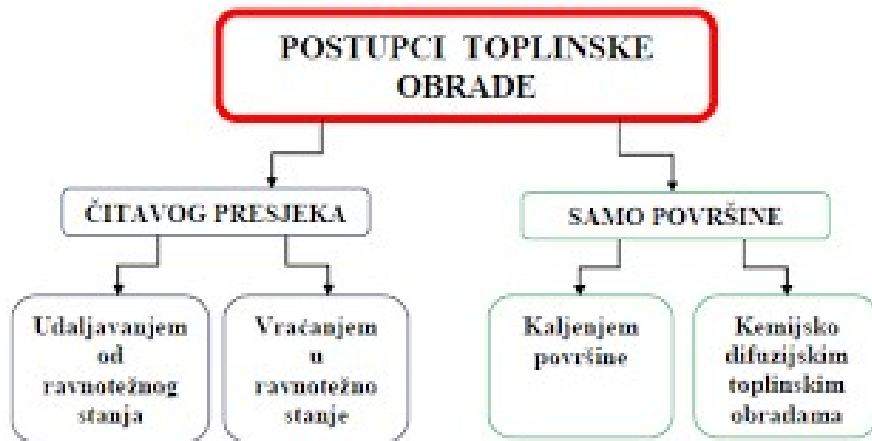
Slika 6. Podjela postupaka toplinske obrade
